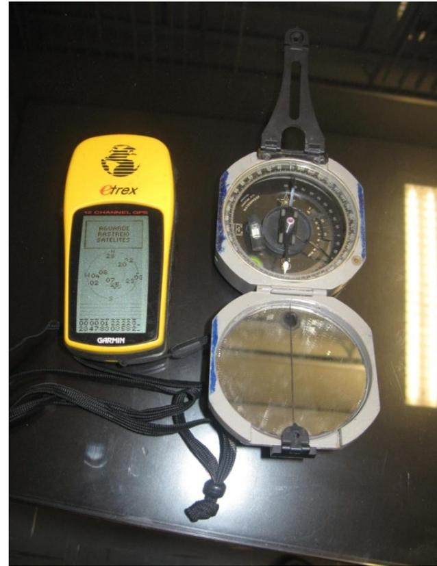
Para a amostragem de bloco orientado mede-se o azimuth (strike) de uma marca de referência (seta horizontal na Figura) traçada sobre um plano da amostra e a inclinação (dip) que este plano faz com a horizontal. O GPS é utilizado para determinar as coordenadas geográficas do sítio de amostragem. O bloco deve estar ‘insitu’.
