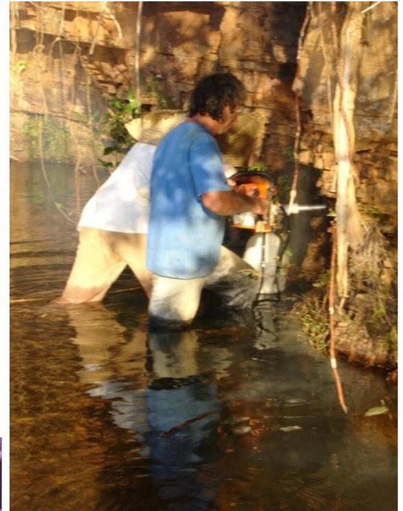
As amostras cilíndricas de 2,5 cm de diâmetro são cortadas em espécimes por 2,2 cm de altura, remarcadas e submetidas aos tratamentos de laboratório.
