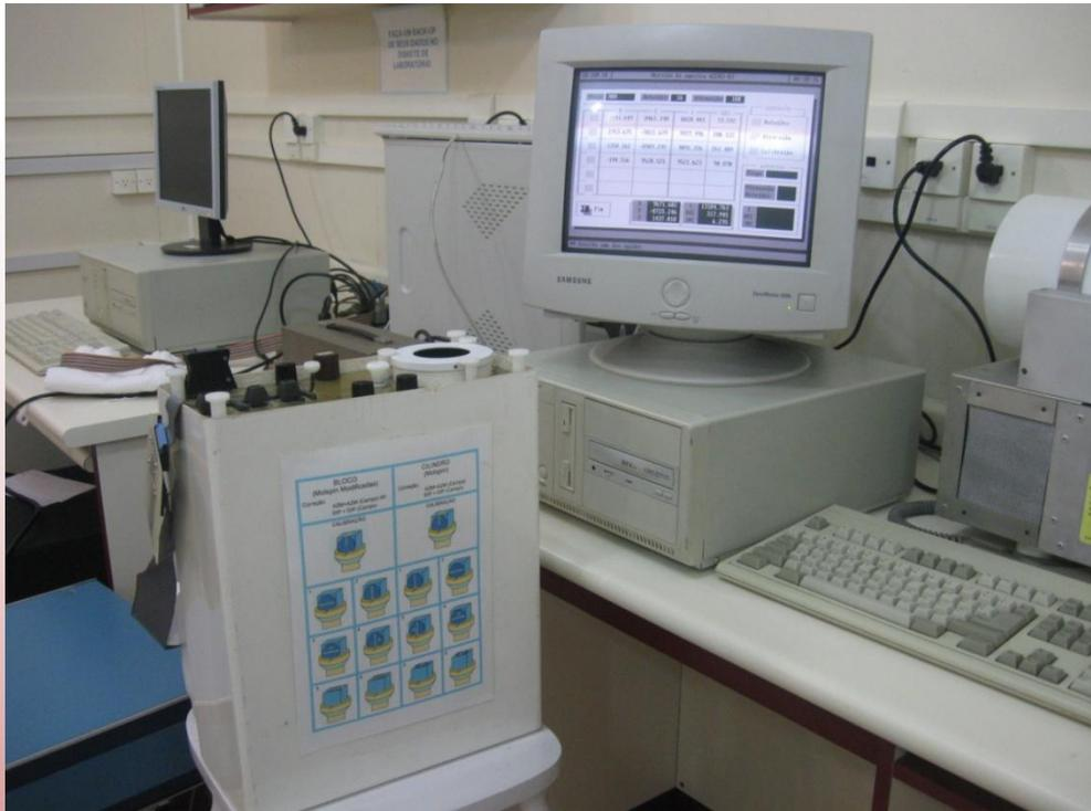
No magnetômetro tipo rotativo (‘spinner’), a mostra gira e o sensor mede a magnetização no plano horizontal. São realizadas 128 medidas a cada giro de  $360^\circ$  da amostra.
