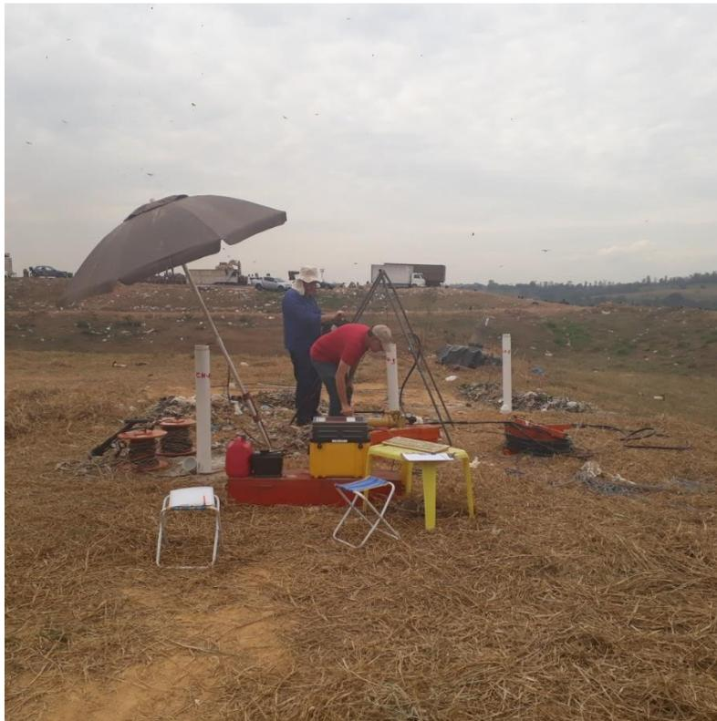
*Figura 4.8: Aquisição de teste crosshole realizado na célula experimental no CH-2.*
