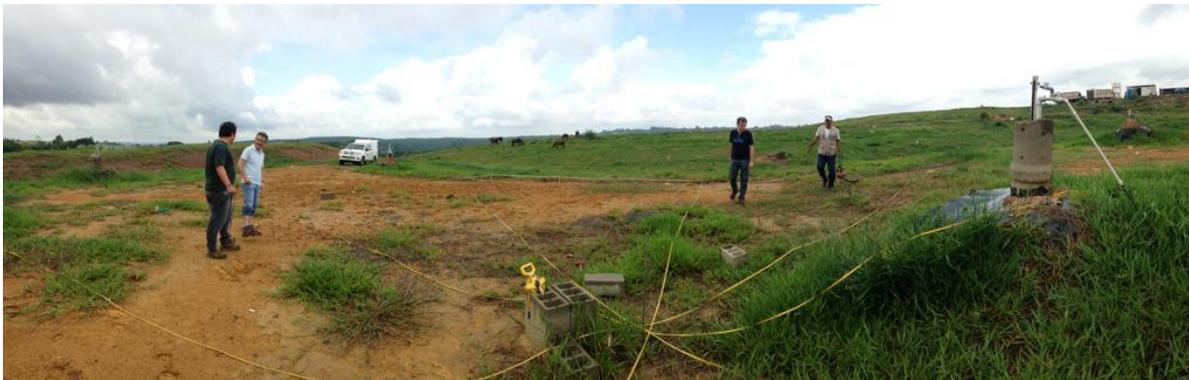
*Figura 4.6: Localização dos geofones em linha de aquisição circular para MASW com fonte passiva.*
