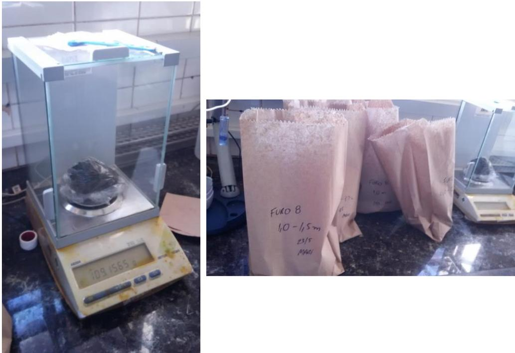
Figura 4.16: Pesagem das amostras e separação para secagem no forno.
