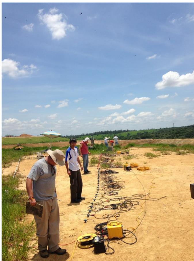
*Figura 4.5: Aquisição de TSR na célula experimental.*
