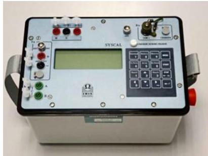
Figura 3.26: Resistivímetro marca Iris, modelo Syscal R1.
