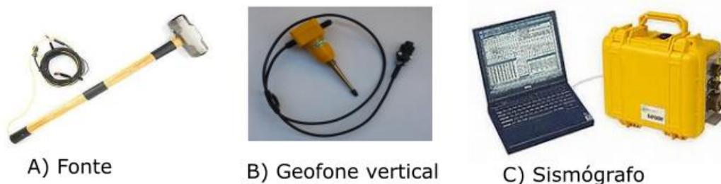
Figura 3.13: Equipamento necessário para levantamento de sísmica de refração. A) Fonte: Marreta de 8 kg. B) Geofone de uma componente (vertical). C) Sismógrafo multicanal.
