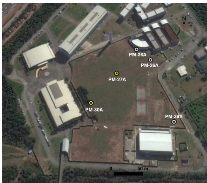
Figura 5.8 – Poços de monitoramento mais profundos que não puderam ser perfilados, devido a interdição do MP: sem constatação de gás (círculos em branco) e com emissão e/ou borbulhamento de gás quando da perfuração (círculos em amarelo).
