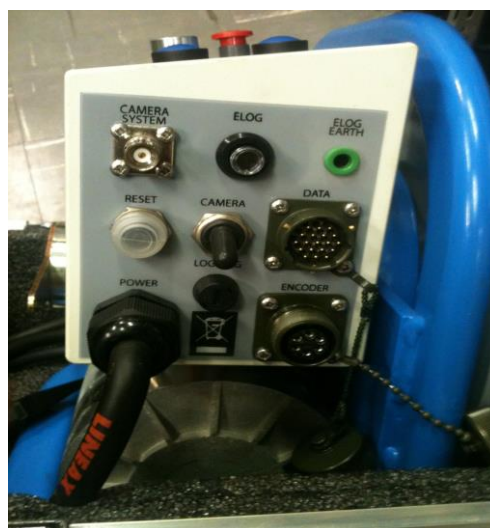
Figura 2.2 – Painel com as conexões elétricas do guincho ( Mini winch 150 m ).
