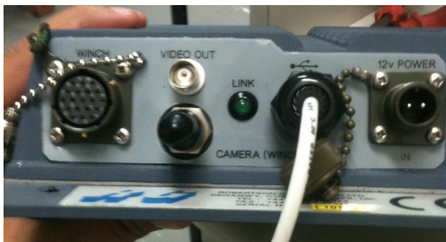
Figura 2.3- Registrador Micrologger II e suas conexões elétricas.
