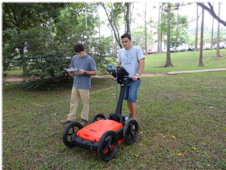
Figura 2.6. Registro fotográfico do background geológico do SCGR-II utilizando o equipamento GPR SIR-4000 com a antena blindada de 270 MHz.
