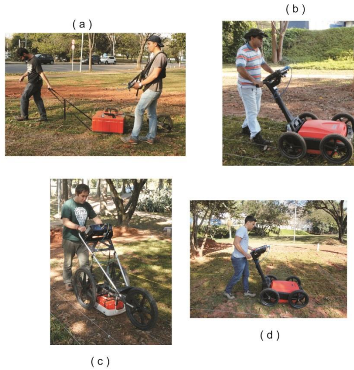
Figura 4.2. Aquisição GPR com antenas de 200 MHz (a), 270 MHz (b), 400 MHz (c), 800 MHz (d) (Dual frequency).
