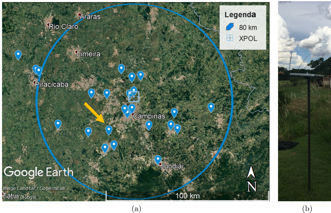
Figura 7 – (a) Rede de hailpads instalada na Região Metropolitana de Campinas com a localização e cobertura de 80 km do radar XPOL. (b) Hailpad instalado na cidade de Indaiatuba, na localização indicada com a seta em (a).
