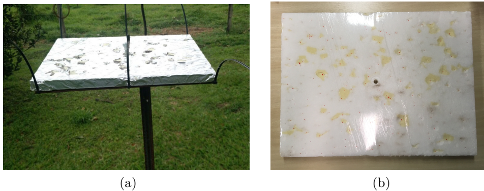
Figura 8 – Placa R004 sensibilizada no sítio (a) e sem a cobertura de alumínio (b).
