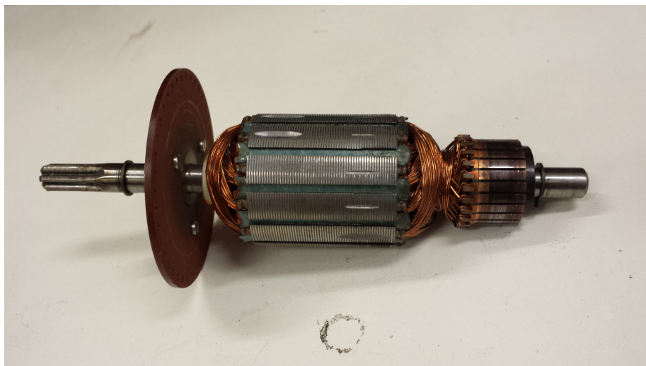
Figura A.6: O rotor com os anéis de trava para apoio dos rolamentos. O disco do encoder é colocado no lugar onde estariam as pás do ventilador
