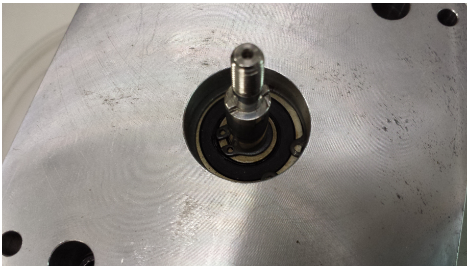
Figura A.5: Inserido o eixo no rolamento e as respectivas travas. Uma das travas prende o rolamento ao suporte e a outra prende o eixo ao rolamento
