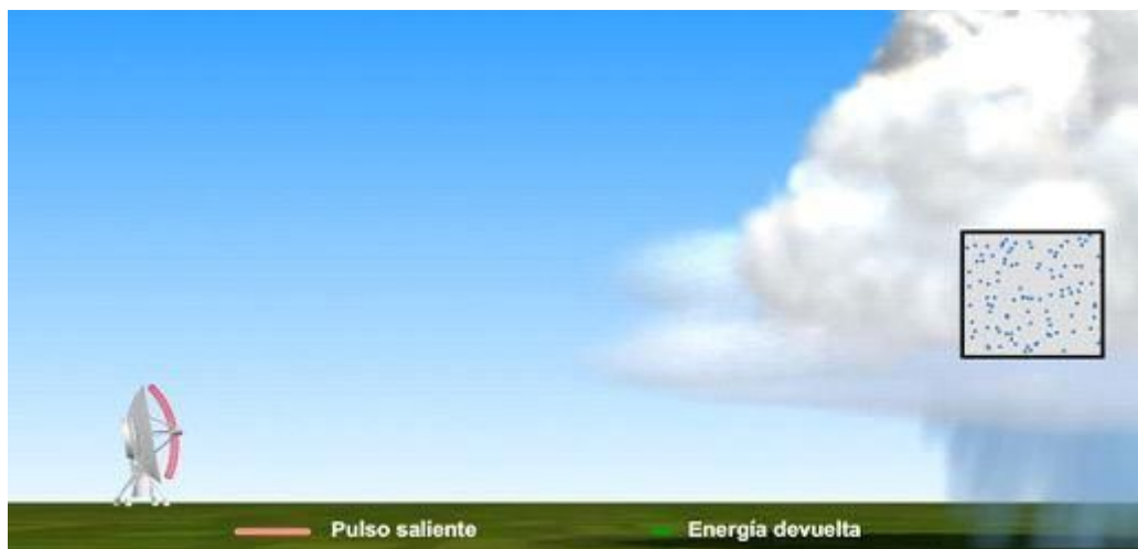
Figura 2.3. Retroespalhamento do sinal eletromagnético emitido pelo radar ao interagir com gotas de chuva. Fonte: COMET Program (2012).
