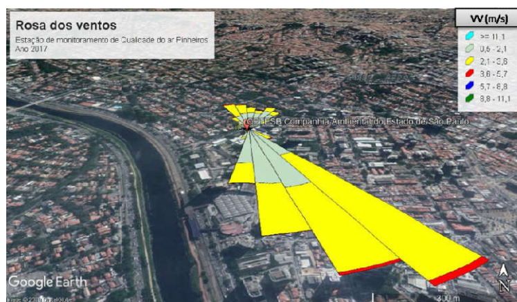
Figura 10: Rosa dos ventos com os dados de velocidade (m/s) e direção do vento ( ^{\circ} ) da Estação Pinheiros de monitoramento de qualidade do ar da CETESB para o ano 2017.
