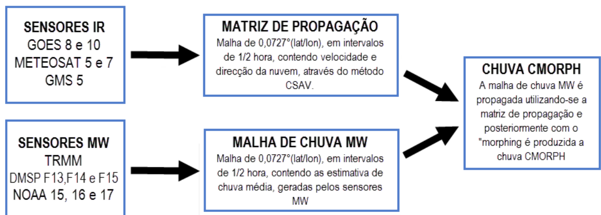
Figura 3.5 Fluxograma da produção de estimativa de precipitação pelo método CMORPH. Adaptado de Araújo (2006).
