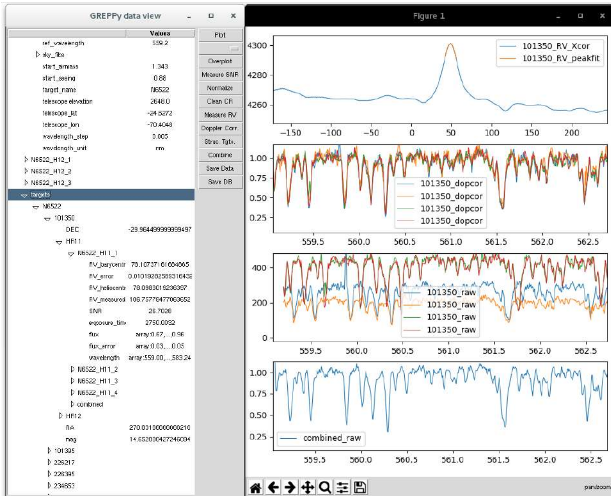
Figura 2.2: Janela do data_view com gráficos exemplificando o uso de algumas ferramentas. A interface possui a opção de plotar gráficos separados e/ou sobrepostos de praticamente qualquer informação contida nas chaves. Os quadros não possuem os nomes dos eixos para aproveitar o máximo espaço possível dentro da janela.
