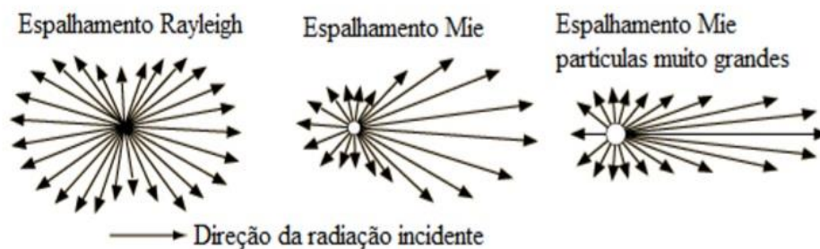
Figura 2.2.1: Representação esquemática da função de fase conforme o regime de espalhamento. (Fonte: Adaptado de http://hyperphysics.phy-astr.gsu.edu/hbase/atmos/blusky.html#c3 . Acesso em: 29 de junho de 2015).
