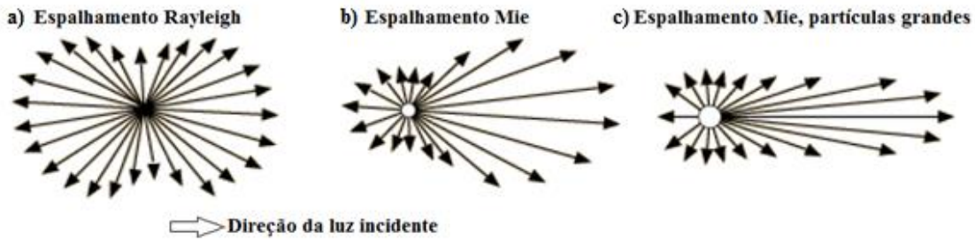
Figura 6: Direção do espalhamento da radiação incidente em função do tamanho da partícula sendo a) espalhamento Rayleigh; b) espalhamento Mie para x \sim 1 ; c) espalhamento Mie para x \gg 1 . (Fonte: disponível em http://hyperphysics.phy-astr.gsu.edu/hbase/atmos/blusky.html . Acesso em 22/02/2015)
