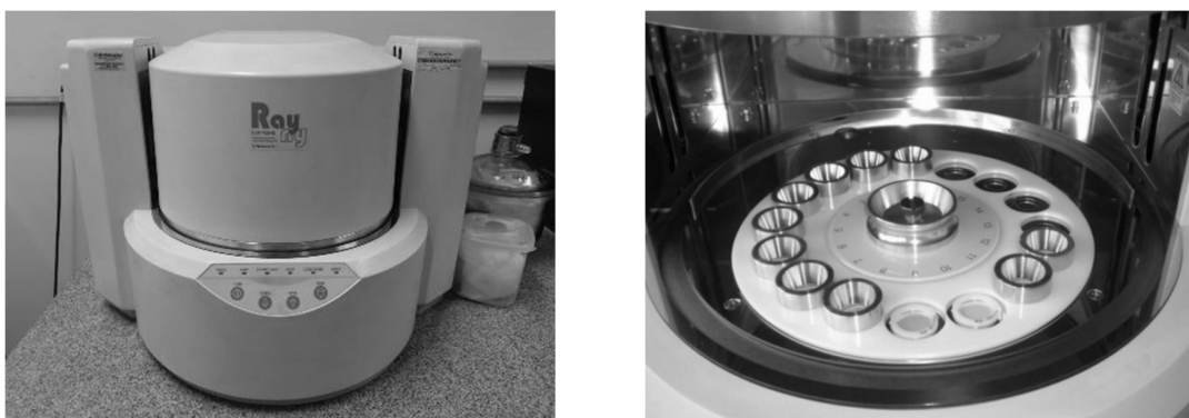
Figura 7. O espectrômetro de fluorescência de raios-X dispersivo de energia (EDX) da Shimadzu modelo 720HS do LAPAt. Na figura à direita observa-se o equipamento aberto contendo as amostras e seus suportes de fixação.
