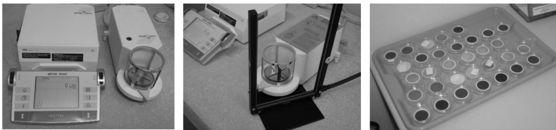
Figura 6. Da esquerda para a direita: Balança de precisão utilizada na pesagem. Eliminador de cargas eletromagnéticas. Filtros carregados de Material Particulado.
