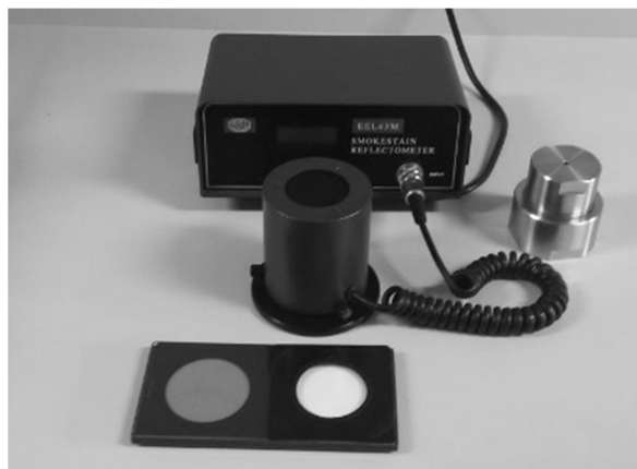
Figura 11. Refletômetro Smoke Stain Reflectometer – model EEL43D da Diffusion System Ltd. A frente do equipamento temos um filtro carregado, à esquerda, e um filtro padrão branco para calibração, à direita.
