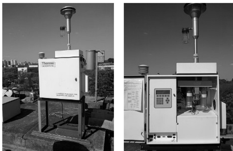
Figura 3. Amostrador Partisol da Thermo Scientific.
