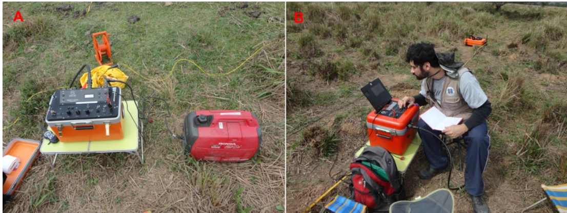
Figura 25: Aquisição de dados TDEM: A) O fio amarelo é usado para montar o loop transmissor de corrente ao qual está conectado ao transmissor de corrente TEM57-MK2 sendo alimentado pelo gerador; B) Ao fundo está a bobina receptora 3D e o receptor PROTEM-D sendo manuseado pelo operador.
