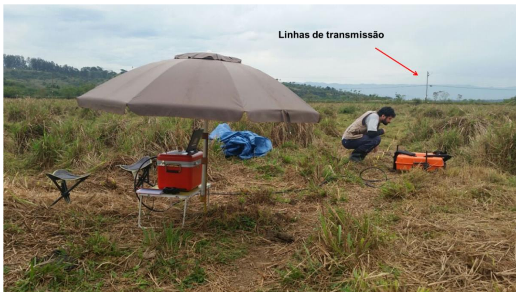
Figura 27: Aquisição TDEM sendo realizada a grandes distâncias do acoplamento Galvânico.
