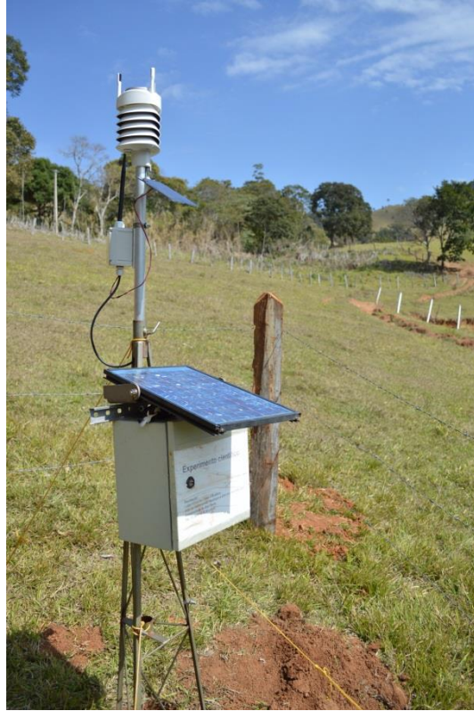
Fig. 3 – Estação Meteorológica (WXT520) instalada na Bacia. Fonte: LCB-IAG.
