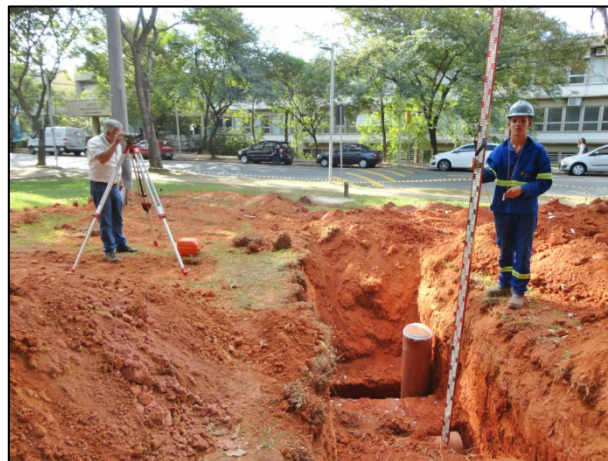
Figura 3.7. Aferição da profundidade do topo dos alvos posicionados nas linhas utilizando-se a estação total Leica TPS-300.
