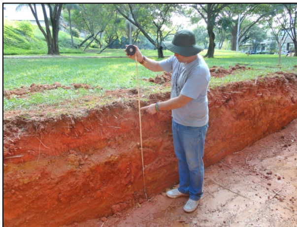
Figura 3.6. Aferição da profundidade das valas escavadas.
