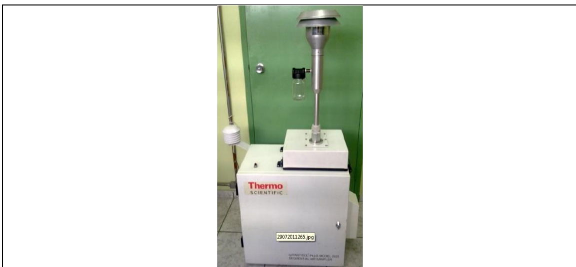
Figura 3.1: Amostrador de material particulado Fino e Grosso tipo Partisol, da Thermo Scientific utilizado na coleta de amostras deste trabalho.
