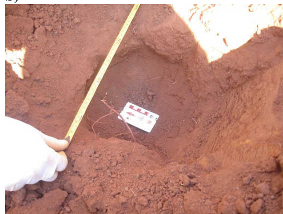
Figura 50. Cavidade presente no solo e causadora da anomalia rasa observada nos perfis adquiridos em X = 3,4 m. a) localização em profundidade. b) vista superior mostrando a extensão lateral.
