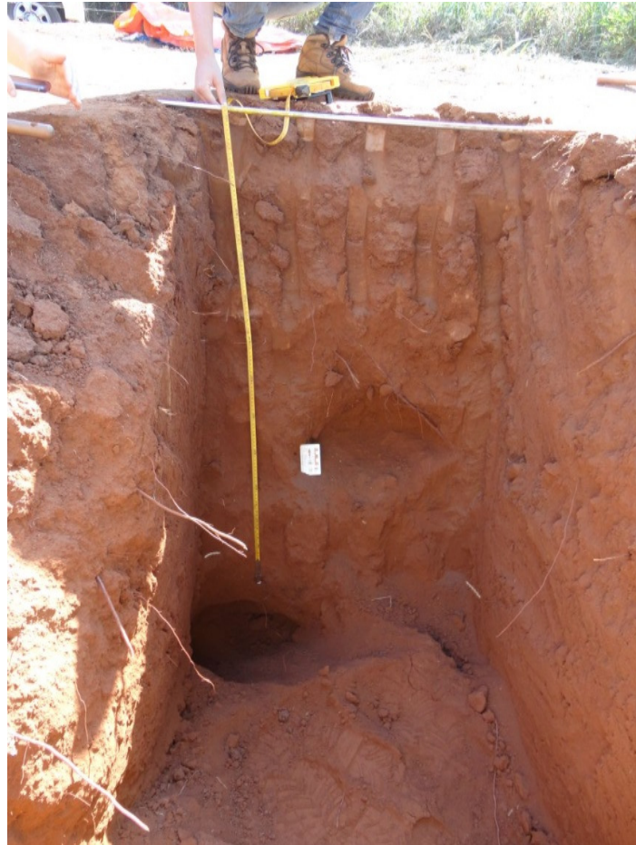
Figura 9. Cavidades encontradas durante a escavação. Estas cavidades são observadas nos radargramas como feições hiperbólicas não relacionadas ao alvo enterrado para execução do experimento.
