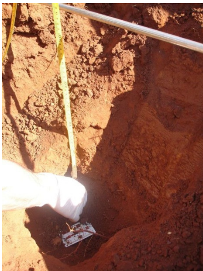
Figura 50. Cavidade presente no solo e causadora da anomalia rasa observada nos perfis adquiridos em X = 3,4 m. a) localização em profundidade. b) vista superior mostrando a extensão lateral.
