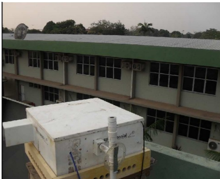
Figura. 4.2: Instrumento MAX-DOAS utilizado na coleta dos espectros em São Paulo/SP.
