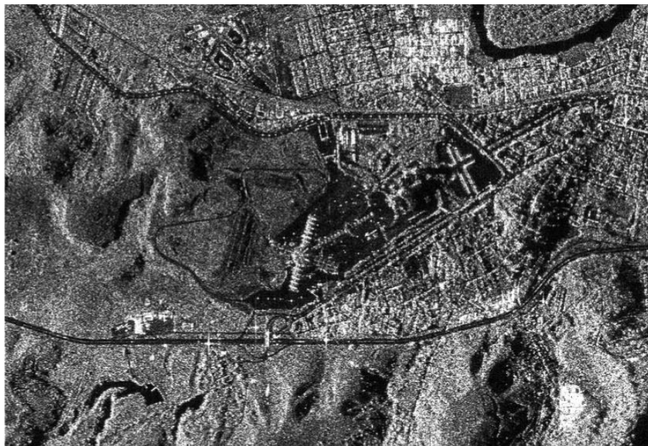
Figura 15: Exemplo de imagem SAR adquirida com pelo SIVAM (Sistema de Vigilância do Amazonas) na cidade de Aparecida do Norte - SP, na banda X. Modificado: Mura (2013).
