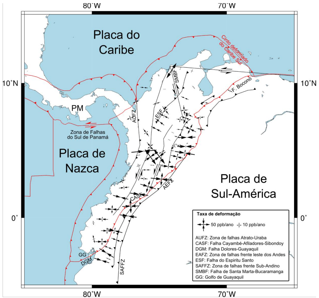
Figura 98: Eixos principais do tensor de taxa de deformação e as principais falhas geológicas dentro do bloco. Nota-se o aumento na obliquidade dos eixos de compressão dentro do bloco do Norte dos Andes, girando sistematicamente como descrito por McCaffrey (2002) para zonas de subducção oblíquas com e particionamento do slip . As setas convergentes indicam deformação de contração, as setas divergentes indicam deformação de extensão, as principais falhas dentro do bloco estão indicadas em preto e os limites das placas em vermelho.
