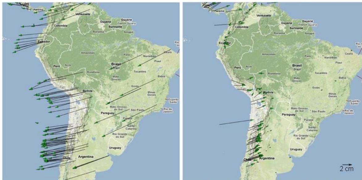
Figura 51: Movimento relativo das estações GPS na placa Sul-Americana usando dois diferentes marcos de referência. Esquerda: placa de Nazca. Direita: parte estável do continente Sul-Americano. Modificado: UNAVCO.
