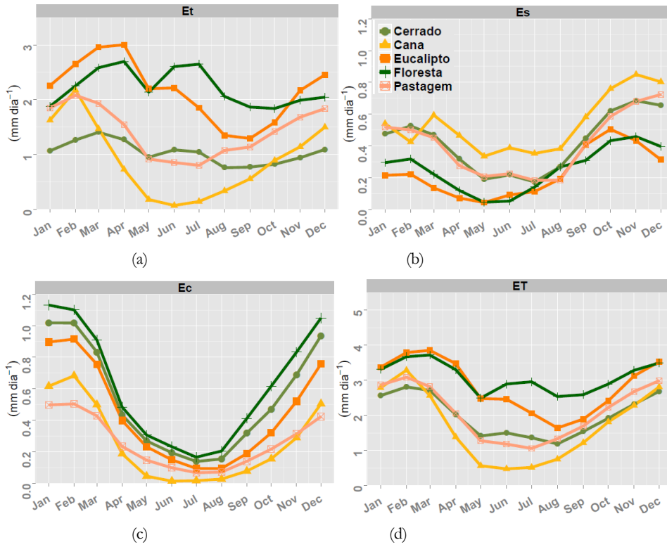
Figura 4.4 – Média nas unidades de resposta hidrológicas (HRUs) da Bacia do rio Piracicaba com diferentes coberturas no período de 2000-2010, depois da implementação da função do IAF sazonalmente e ajuste manual de parâmetros para: (a) Transpiração (Et), (b) evaporação do solo (Es), (c) evaporação da água interceptada pelo dossel (Ec) (e) evapotranspiração (ET)
