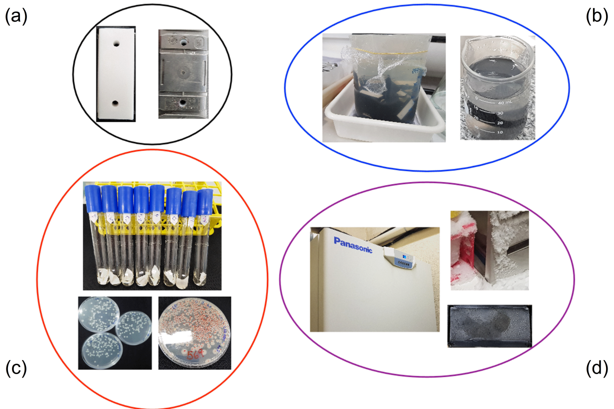
Figura 5.22: Aponta-se aqui, os trabalhos realizados na Faculdade de Medicina de Ribeirão Preto, que tinham como objetivo construir, testar e garantir certos parâmetros mínimos dos materiais específicos embarcados na sonda (peças e filtros). Em (a) aponta-se peças construídas para proteger os filtros. Já em (b) destaca-se o processo de esterilização de algumas peças embarcadas na sonda. Em (c) aponta-se o processo de esterilização dos filtros. Em (d) os testes mecânicos em baixas temperaturas.
