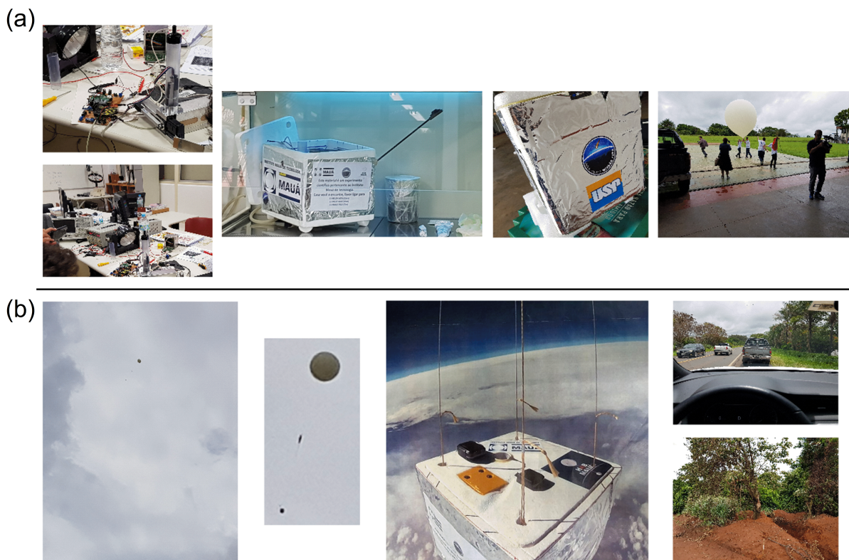
Figura 5.23: Voo da sonda suborbital. Destaca-se o processo de montagem da estrutura, o voo e recuperação da carga embarcada. Em (a) é mostrado a montagem, o processo de esterilização e a preparação para o voo. Já em (b) mostra-se o voo, seu acompanhamento e a recuperação da carga.
