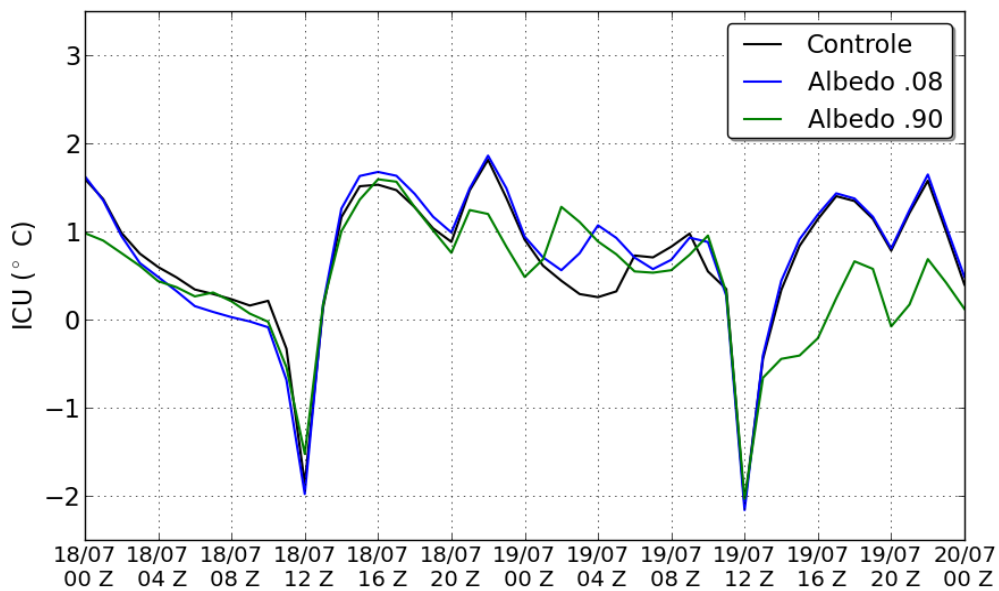
Figura 4.1 – Evolução diária da intensidade da ICU para um ponto central da RMSP. A linha preta representa a simulação controle, a linha verde a simulação com albedo do telhado igual a 0,08 e a linha vermelha a simulação com o albedo do telhado igual a 0,90.
