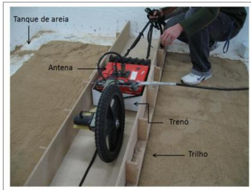
Figura 3.4: Antena GPR de 400 MHz modelo SIR-3000 (GSSI) sobre o trilho de madeira.
