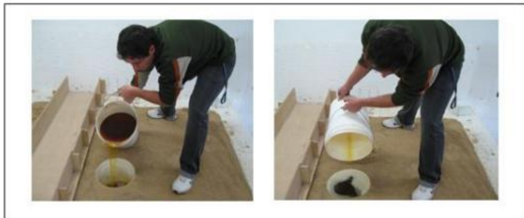
Figura 3.3: Derrame de 15 litros do óleo alquibenzeno no tubo de PVC.
